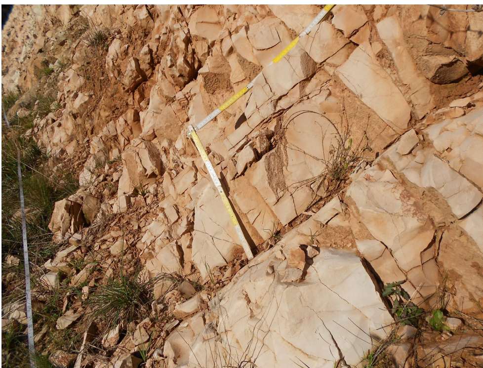
Particolare della spaziatura decimetrica tra i giunti del sistema principale
