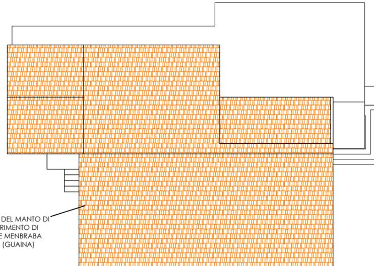
RIFACIMENTO COMPLETO DEL MANTO DI COPERTURA CON INSERIMENTO DI ISOLAMENTO TERMICO E MEMBRABA ELASTOPLASTIMERICA (GUAINA)
