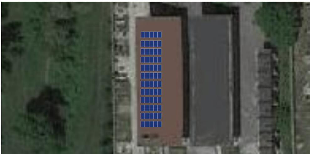
Tale disposizione dei moduli deriva soprattutto da un accurato studio di micrositing per individuare i punti dell'area oggetto di intervento più critici dal punto di vista di perdite per ombreggiamento dell'impianto fotovoltaico.
